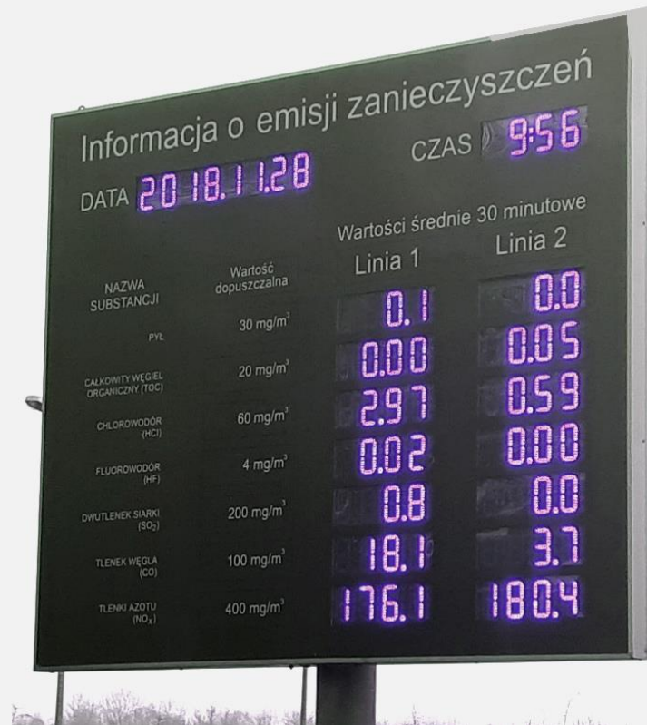
Tablica informacyjna Krakowskiego Zakładu Termicznego Przekształcania Odpadów pokazująca wartości rzeczywistych emisji instalacji w stosunku do wartości dopuszczalnych przepisami
